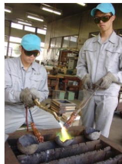
束ねた銅線を溶かしてインゴットにする
