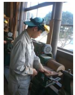
資料通りの大きさ・形状の元型を木工旋盤で製作する(鐸身部分)
