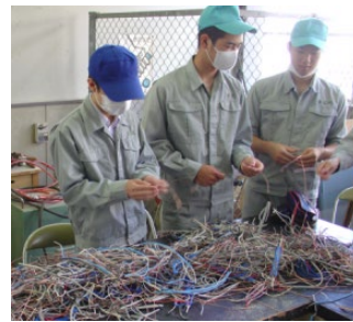
材料となる銅は電気工事実習の銅線の廃材を利用、ひたすら膨大な量の塩ビ被覆をむく
